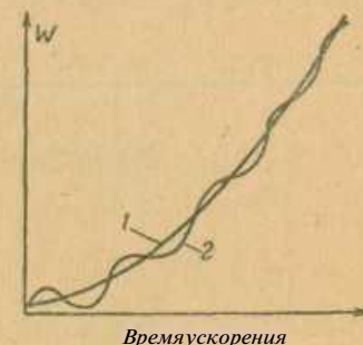
Рис. 2. График, поясняющий действие автофазировки. 1 — нарастание энергии равновесной частицы; 2 — нарастание энергии не равновесной частицы.
