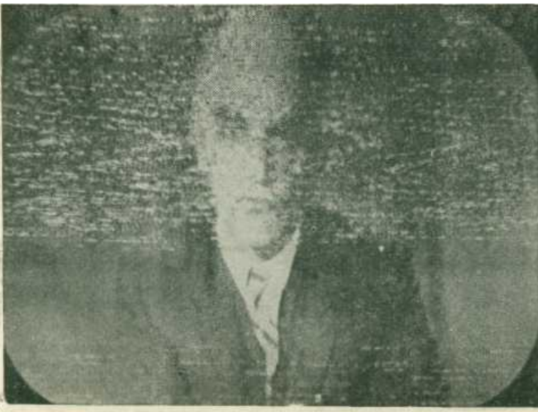
Рис. П.30. Искажение изображения, вызванное неисправностью на высоковольтной линии при \frac{E_c}{E_n} = 18 \text{ дб}
