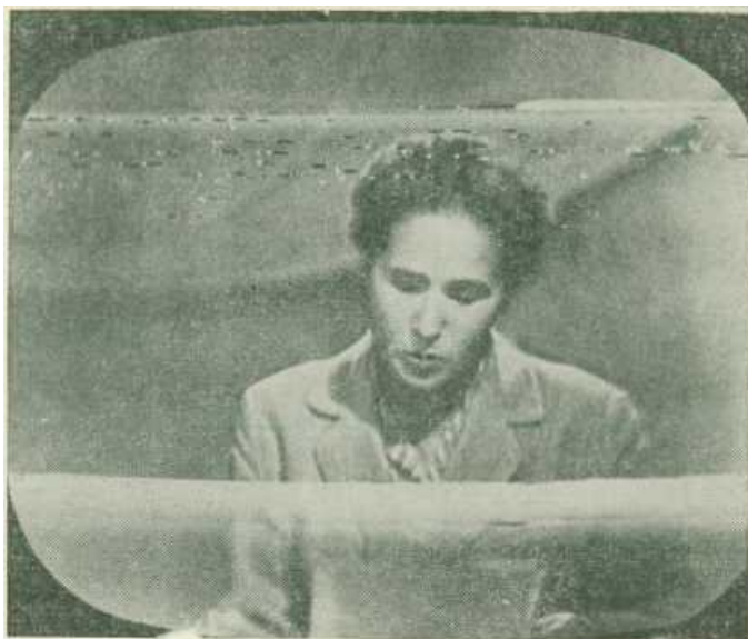
Рис. П. 33. Искажение изображения, вызванное работой автотранспорта при \frac{E_c}{E_n} = 0 \text{ дб}
