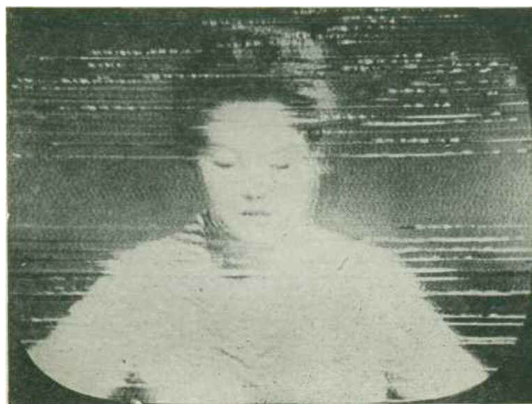
Рис. П.31. Искажение изображения, вызванное неисправностью на высоковольтной линии при \frac{E_c}{E_n} = 16 \text{ дб}
