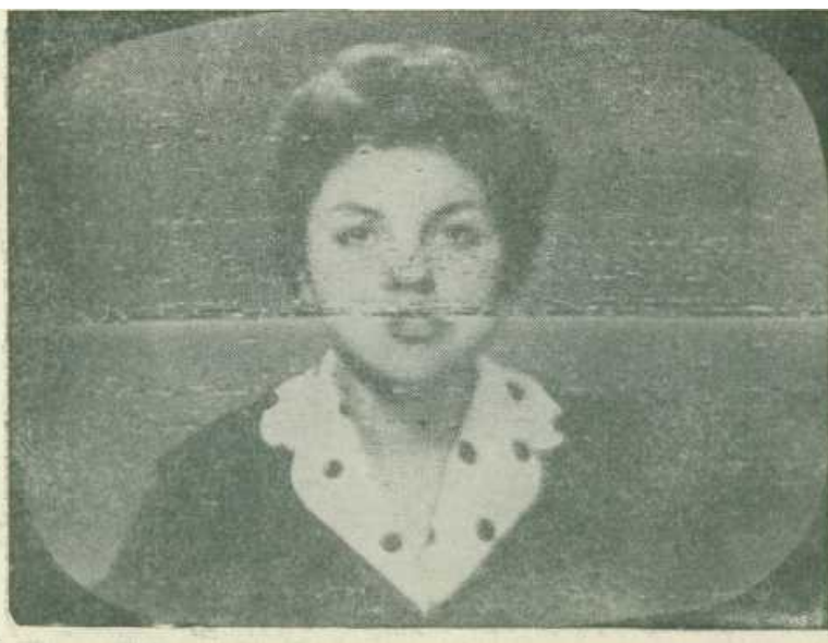
Рис. П.18. Искажение изображения, вызванное работой коллекторного мотора при \frac{E_c}{E_n} = 14 \text{ дб}
