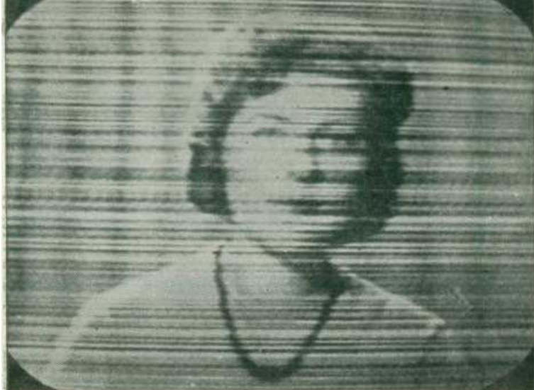
Рис. П.5. Искажение изображения, вызванное чрезмерно большим сигналом, создаваемым усилителем
