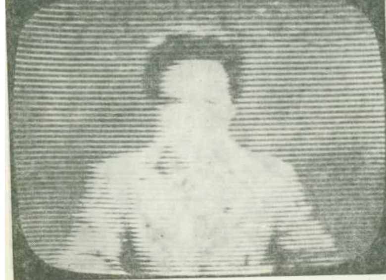
Рис. П.7. Искажение изображения, вызванное одновременным приёмом двух телевизионных центров
