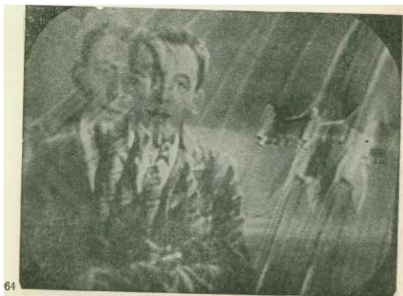
Рис. П.38. Искажение изображения, вызванное воздействием отражённого сигнала
