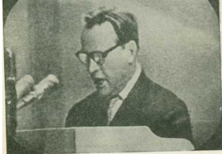
Рис П39. Искажение изображения, вызванное воздействием отражённого сигнала
