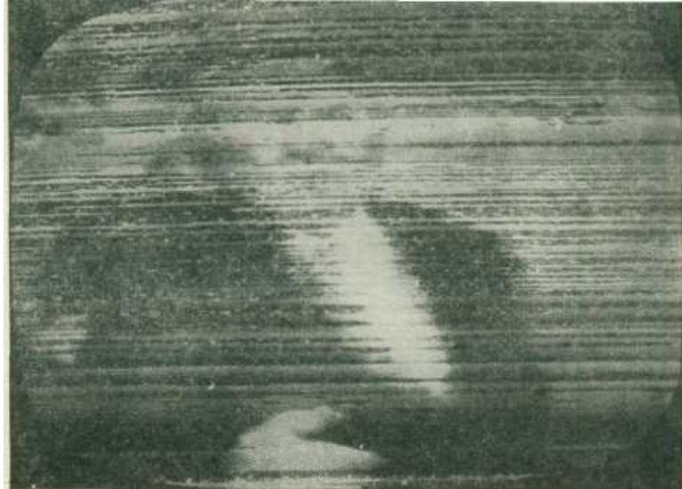
Рис. П.13. Искажение изображения, вызванное наличием более длительного искрового промежутка при \frac{E_c}{E_n} = 0 \text{ дб}
