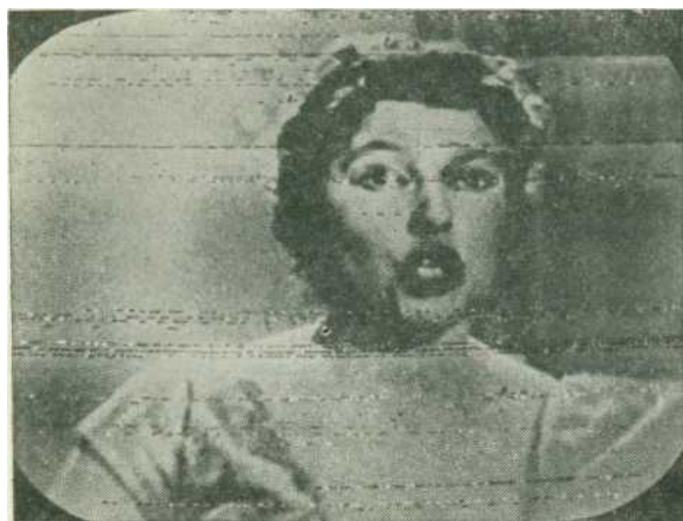
Рис. П.23. Искажение изображения, вызванное работой швейной машины при изменении давления на педаль, \frac{E_c}{E_n} = 14 \text{ дб}
