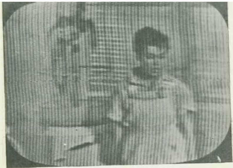
Рис. П.3. Искажение изображения, вызванное излучением радиопередатчика при \frac{E_c}{E_n} = 14 дб, f_c = 49,75 Мгц, f_n = 59,8 Мгц
