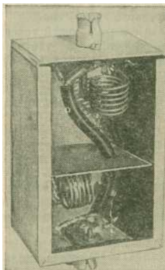
Рис. 4. Конструкция узкополосного режекторного фильтра
