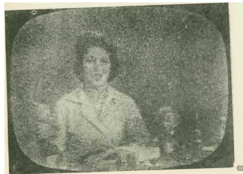
Рис П40 Искажение изображения, вызванное собственными шумами приёмника
