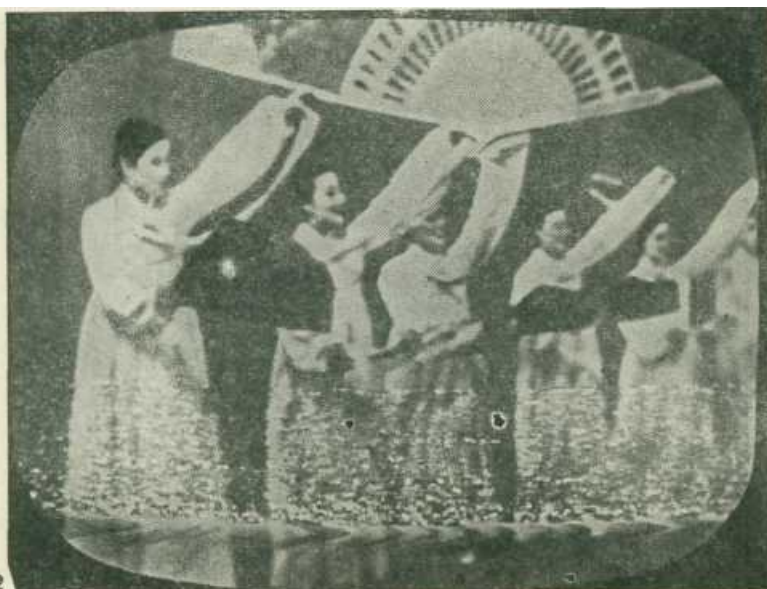
Рис. П.14. Искажение изображения, вызванное работой терморегулятора при \frac{E_c}{E_n} = 23 \text{ дб}
