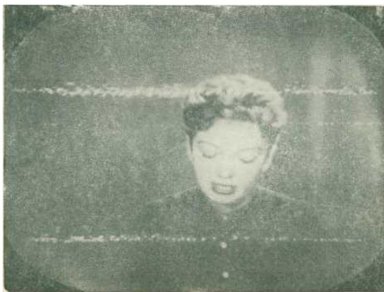
Рис. П.26. Искажение изображения, вызванное работой счётной машины при \frac{E_c}{E_n} = 26 \text{ дб}
