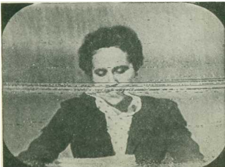
Рис. П.22. Искажение изображения, вызванное работой швейной машины при постоянной скорости вращения электродвигателя, \frac{E_c}{E_n} = 20 \text{ дб}
