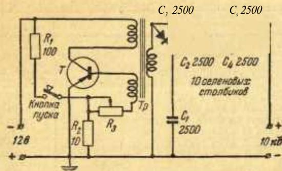
Рис. 25. Схема высоковольтного преобразователя с селеновыми выпрямительными столбиками.
