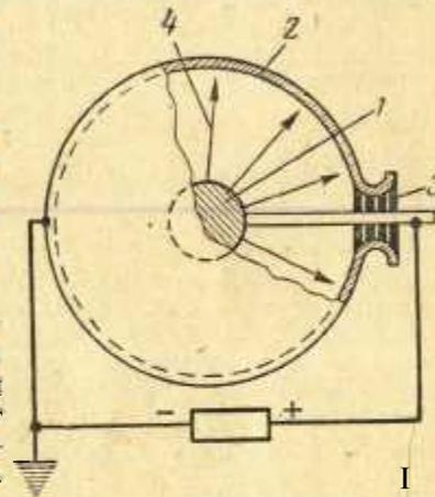
Рис. 17 - Схематическое устройство высоковольтного атомного элемента.
