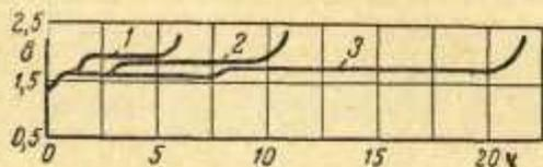
Рис. 4. Зарядные характеристики серебряно-цинкового аккумулятора.
