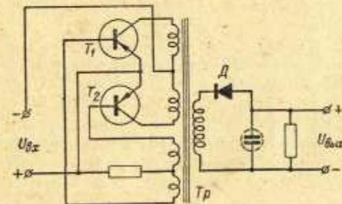
Рис. 23. Простейшая схема "двухтактного" преобразователя напряжения.
