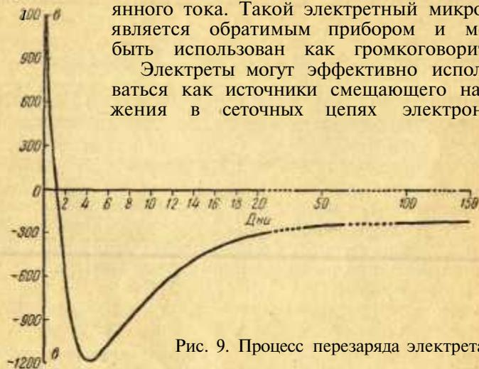
Рис. 9. Процесс перезаряда электрета.
