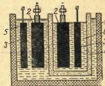
Рис. 6. Схематическое устройство газового аккумулятора.
