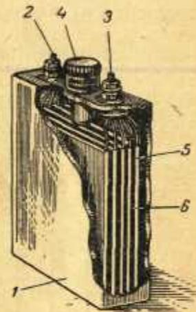
Рис. 3. Устройство серебряно-цинкового аккумулятора.
