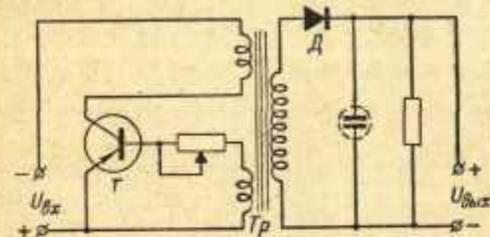
Рис. 22. Простейшая схема однотактного преобразователя напряжения.
