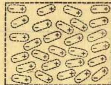
Рис. 7. Схематическое изображение постоянной ориентации молекул в электрете.
