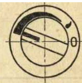
Позиция „в“ открыт подвод газа на горелку и запальник
