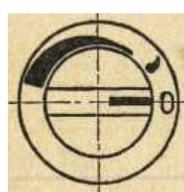
Позиция „а“ закрыт подвод газа на главную горелку и запальник
