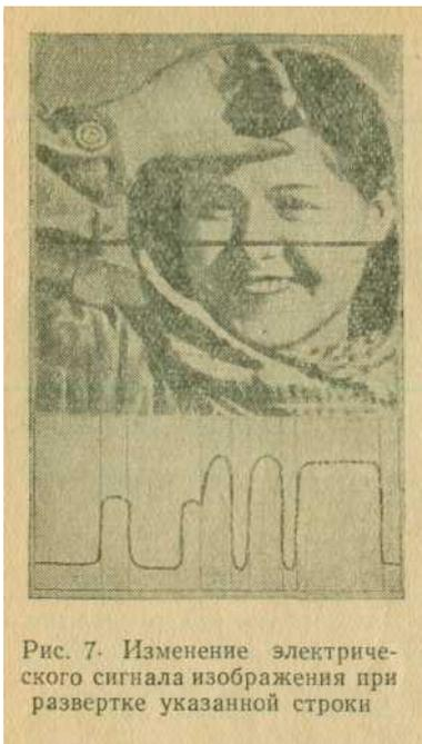
Рис. 7. Изменение электрического сигнала изображения при развертке указанной строки
