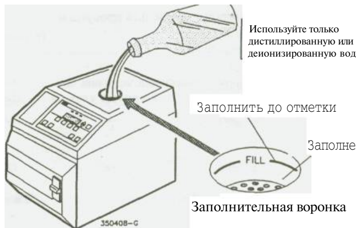
Фигура 2-2. Наполнение резервуара
