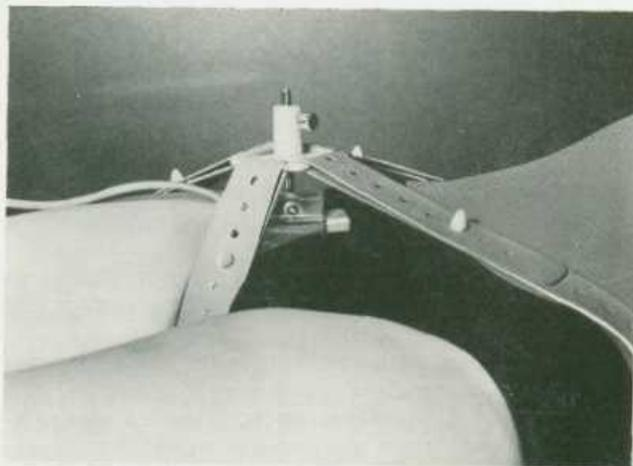
датчик артерального пульса с крепежными элементами
